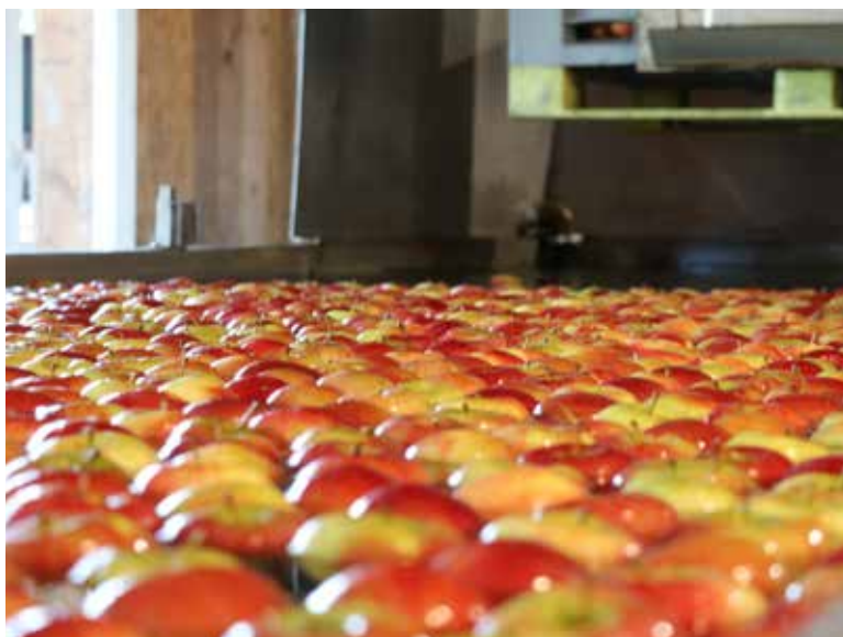
Flottaison : le robot fait basculer les pommes en douceur dans la ligne de tri.
